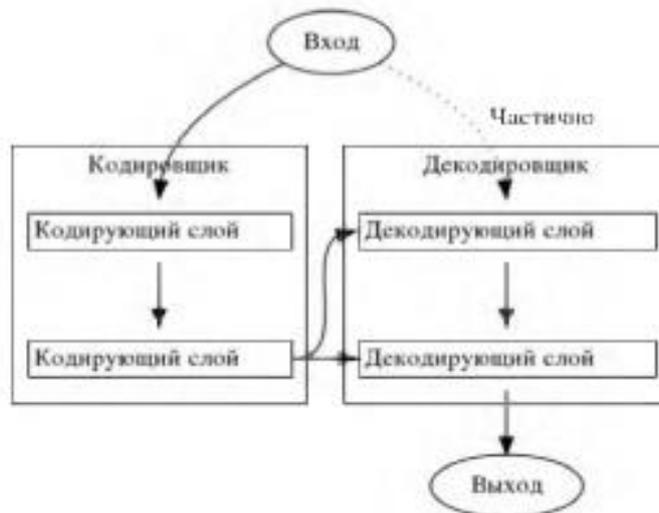
Рисунок 2 – Общая схема архитектуры трансформера
